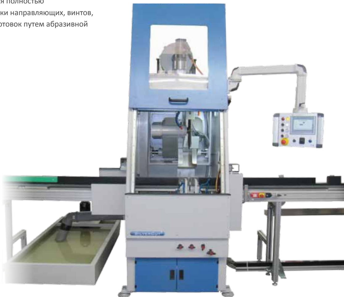
Панель управления с сенсорным экраном и джойстиком для сервооси отрезного диска.
