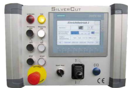
Bedienfeld mit Touch-Display und Joystick für die Servoachse der Trennscheibe.
