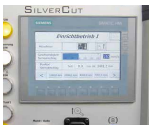
Bedienfeld mit Touch-Display und Joystick für die Servo-Achse der Trennscheibe.
