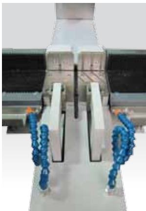
在切口旁边的左右两侧有双边物料夹紧装置。
