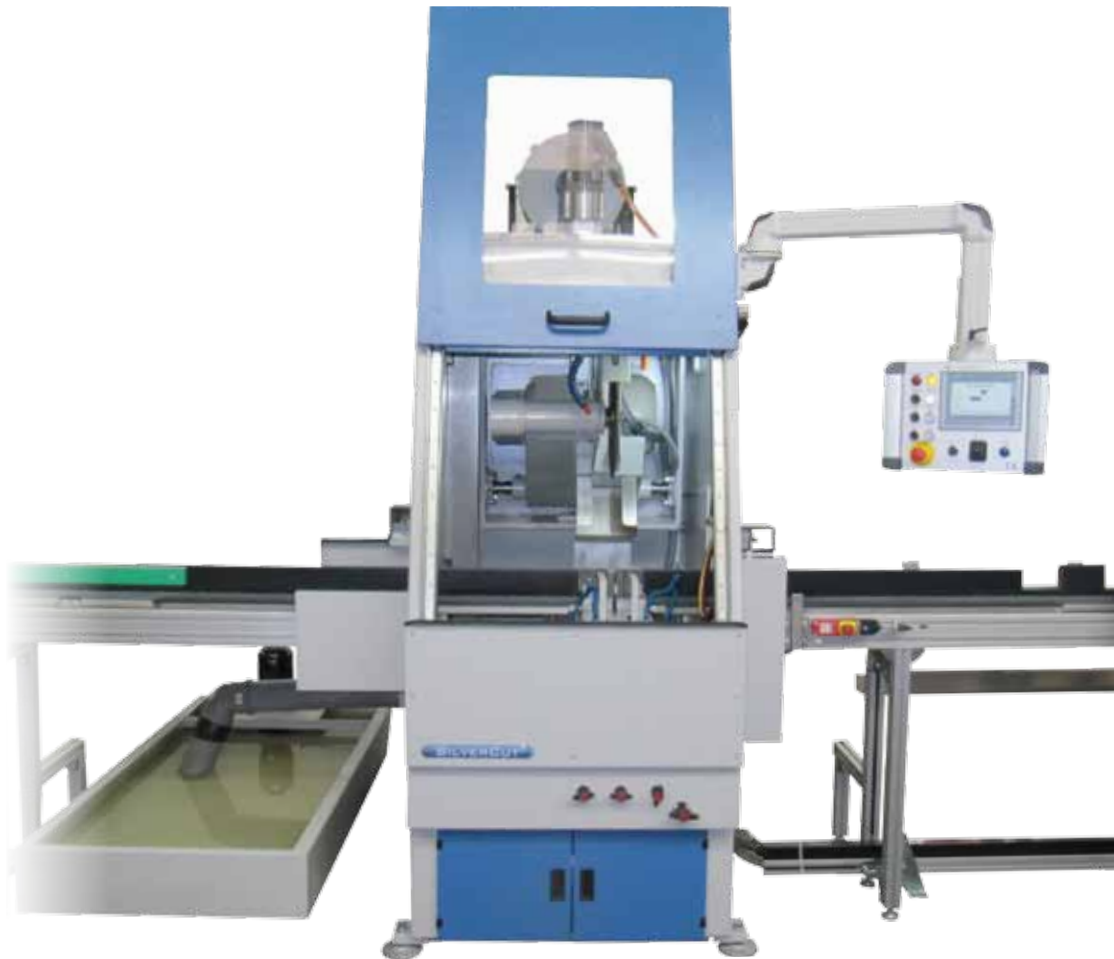
触控显示屏和操纵杆，用于切割轮的伺服轴。
