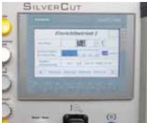
触控显示屏和操纵杆，用于切割轮的伺服轴。
