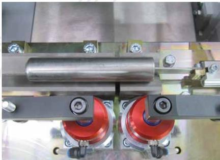
**Prismenspannung mit zwei pneumatischen Schwenkspannern** [optional] und digitalem Werkstückanschlag.
