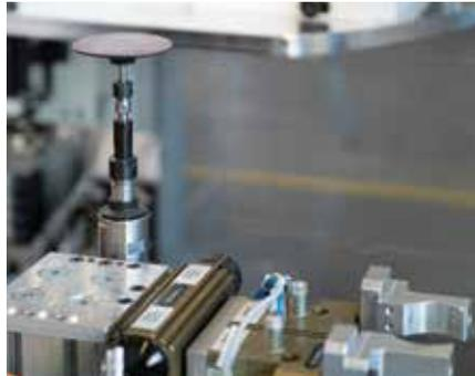
Der Roboter entnimmt ein Rohteil und legt es nach typspezifischen Abläufen (z.B. Entgraten, Wenden) in die Säge ein.
