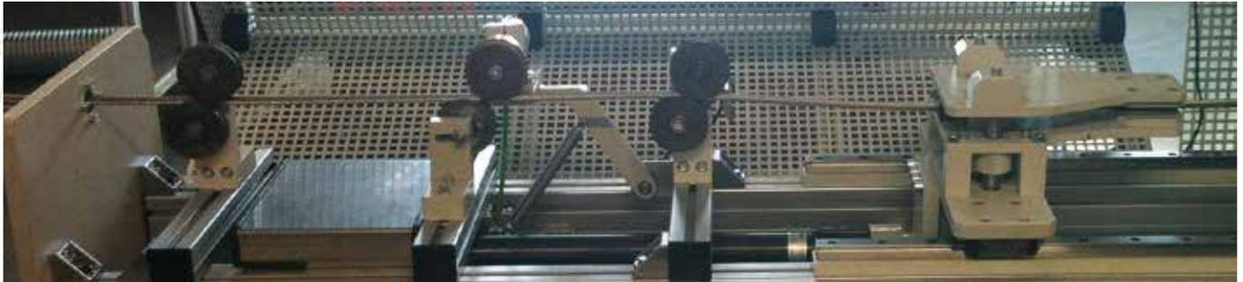
Automatische Kontrolle von Rollenzuführung und Zangenvorschub.
